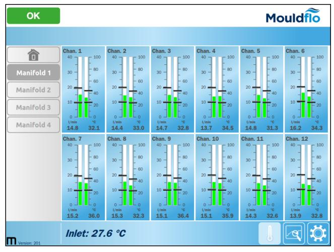
Les diagrammes à barres de cet écran représentent le débit et la température de chaque capteur relié à la nourrice de distribution sélectionnée. Si des seuils ont été fixés pour le capteur, ils sont représentés par des traits horizontaux sur le diagramme à barres. Le capteur de température d'admission sélectionné est également affiché au bas de l'écran (Inlet).
